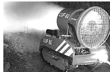
La mission d'un robot consiste à s'approcher du foyer de l'incendie, à mesurer les températures dans le tunnel et à signaler les données respectives à une centrale. Dans la plupart des cas, les robots sont équipés d'un équipement d'extinction mobile à utiliser en fonction des conditions existantes sur site.
